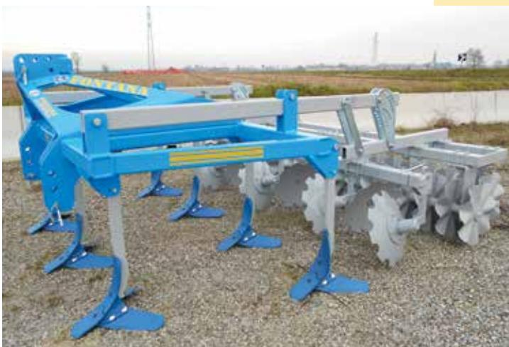
Coltivatori ad ancore rigide su 2 o 3 file, dischi colmatori e gruppo finitore per lavorazione terreno e interramento residui
