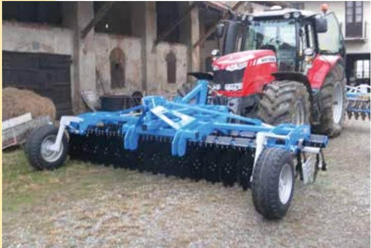
Dissodatori anteriori con lame curve tipo Michel e ruote di regolazione profondità.
