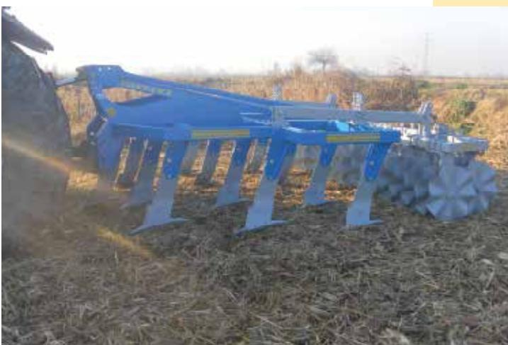
Dissodatori a lame curve su una, due o tre file dotati di ruote, rulli o dischi finitori.
