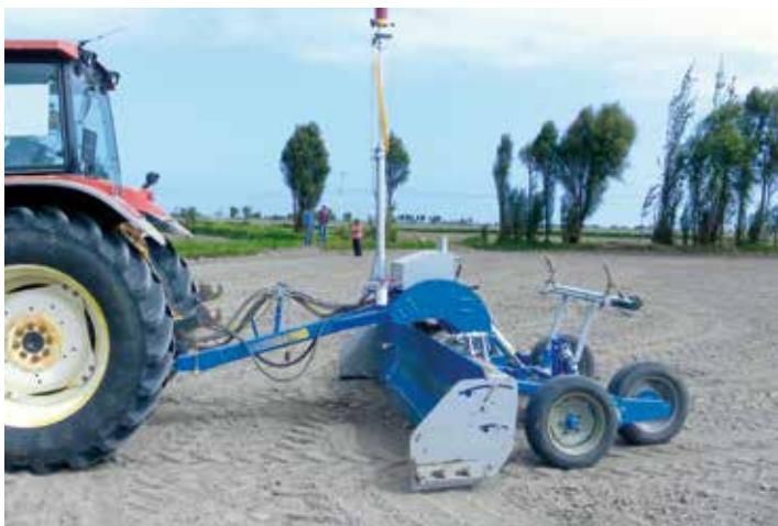
Livellatrici idrauliche modulari automatiche predisposte per controllo laser a piano orizzontale e a doppia pendenza con sistema ricevente singolo o doppio, sensori pendenze e GPS.
