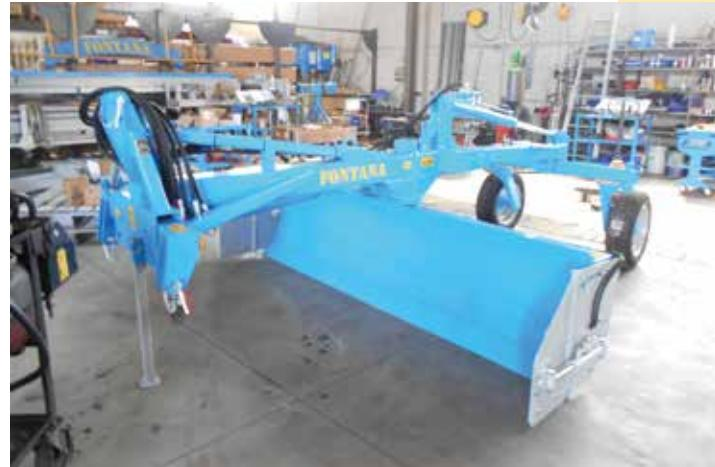
Livellatrici anteriori totalmente idrauliche modulari automatiche per skid steer loader, terne, sollevatori telescopici, trattori.
