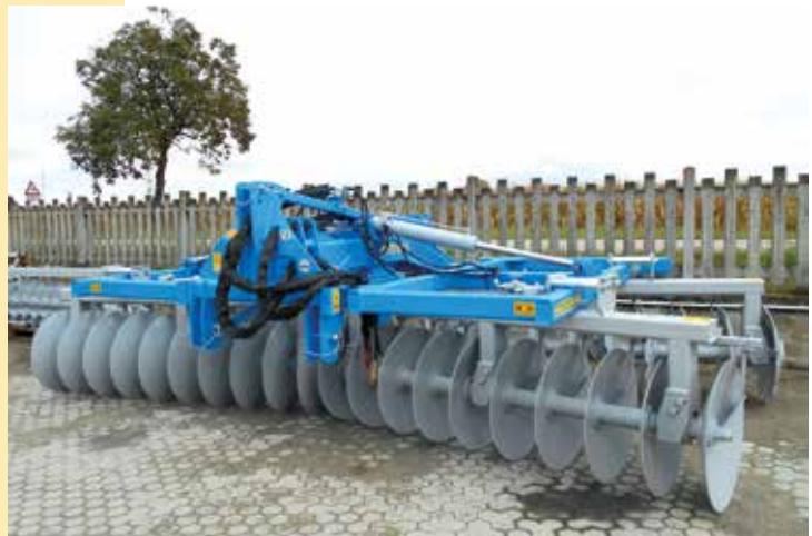
**Erpici a dischi compatti ammortizzati** su balestre o cilindri in gomma
