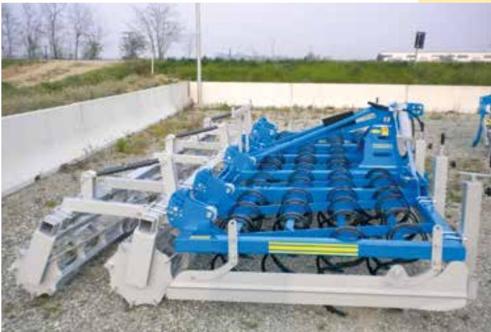
Vibrocoltivatori combinati per la preparazione rapida del letto di semina dotati di barre livellatrici, ancore, molle, dischi, rulli
