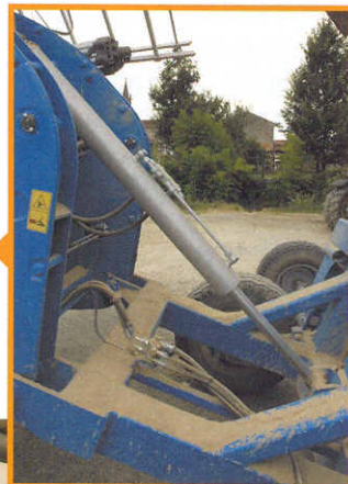
Pistone principale e snodo sono gli unici due punti da ingrassare tutti i giorni.
