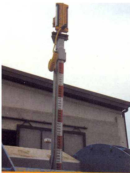
Anche il ricevitore laser è a controllo idraulico.
