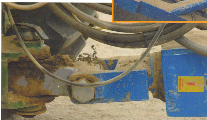
Pistone principale e snodo sono gli unici due punti da ingrassare tutti i giorni.
